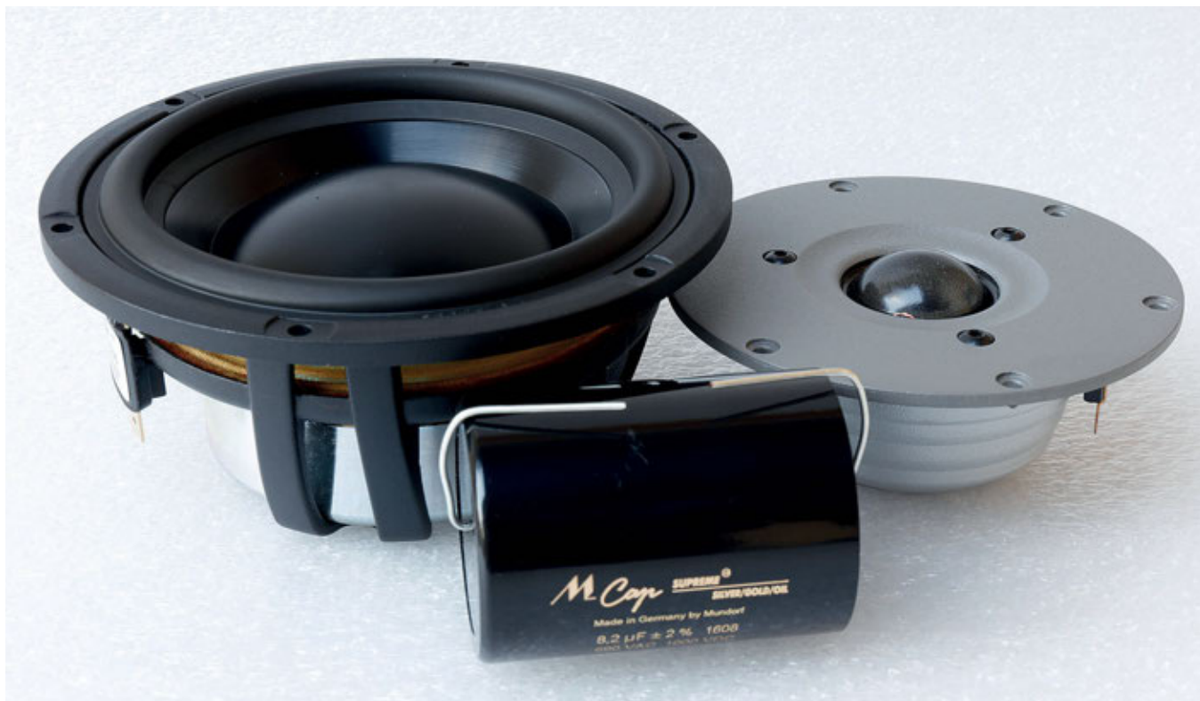
Il condensatore è in polipropilene di elevata qualità Mundorf M Cap Supreme Silver Gold Oil in serie al tweeter. Questi condensatori sono selezionati e accoppiati con una tolleranza inferiore allo 0,1%. Il woofer da 5 pollici di diametro è costruito su specifiche. La bobina è in alluminio immersa in ferrofluido, la frequenza di risonanza è molto bassa, intorno ai 600 Hz.
