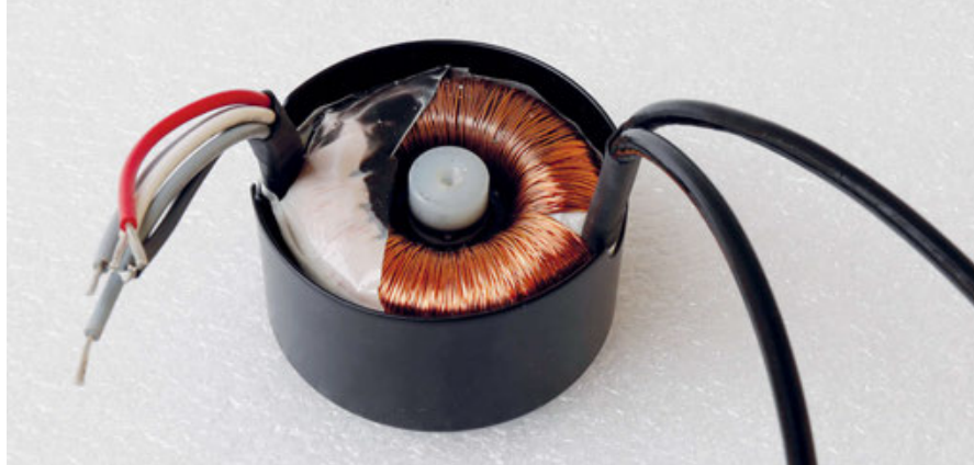
Uno dei due trasformatori toroidali nella sua gabbia magnetica e meccanica. La parte filettata centrale, usata per ancorare il componente, è in nylon, in modo da non interferire con il campo magnetico.
