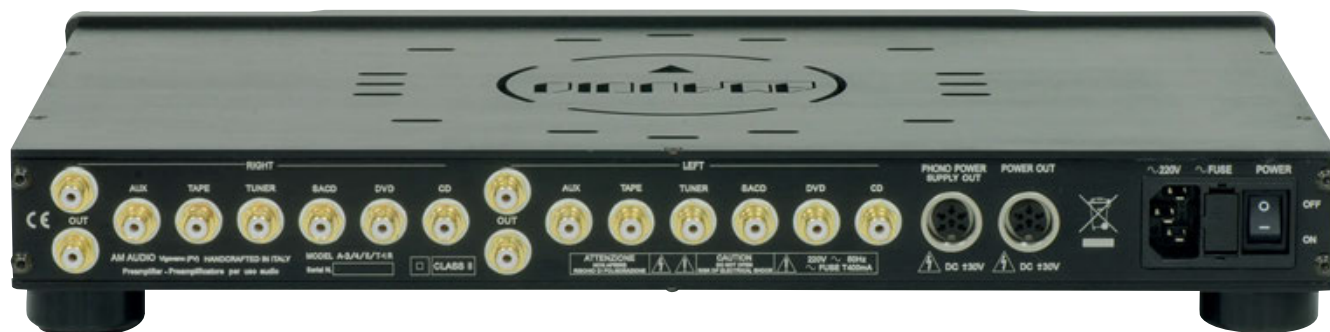
Sei ingressi linea sbilanciati e due coppie di uscite, oltre alle prese ausiliarie per alimentare unità esterne quali ad esempio dei pre fono.
