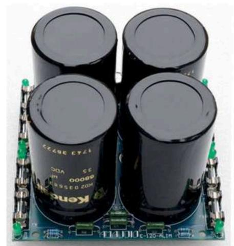
La scheda dei condensatori di filtro per i mosfet di potenza monta 4 Kendeil da 68.000  $\mu$ F caricati a 26 volt, per un magazzino energetico complessivo di oltre 90 joule.
