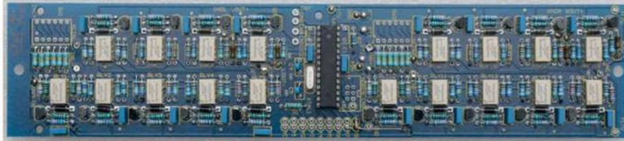
La scheda di regolazione del volume, identica a quella montata nel preamplificatore P-1X.
