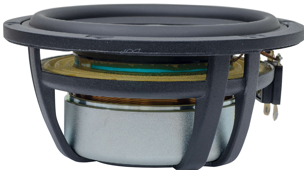
Dotato di gruppo magnetico al neodimio più ferri- te e di bobina mobile da ben 75 mm di diametro realizzata con filo in alluminio, il piccolo midwoofer si dichiara in grado di supportare fino a 1.000 W impulsivi e 200 W a norma DIN.
