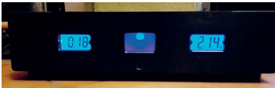
La prima versione dell'isolatore era dotata di indicatori digitali della corrente assorbita e della tensione di rete.
